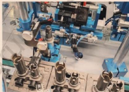
ORIENTAMENTO, ANGOLARE, CONTROLLO E CARICO AUTOMATICO
